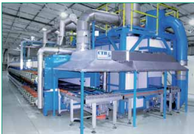
4. ábra. A tömegáram kiegészítő szenzorok nélküli közvetlen mérése a technológiai kemencékben pontos sztöchiometrikus égést tesz lehetővé
