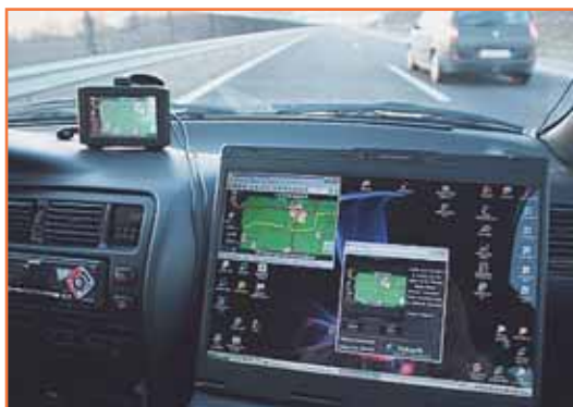
29. ábra. Navigációs eszközök TMC tesztje közlekedő járműben, az M3 autópályán
