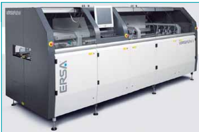
3. ábra. Versaflow 3/45 szelektív forrasztó gép kívülről. A belső a vevő szükségei és igényei szerint számtalan variációban készülhet.
