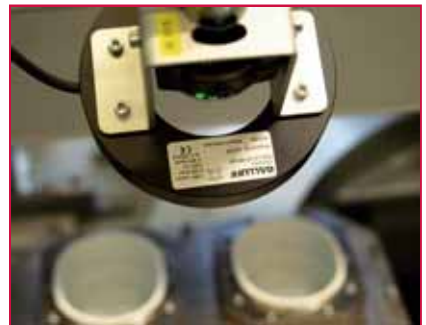
2. ábra. Vision szenzor ellenőrzi a poharak jelenlétét és a megfelelő töltöttséget
