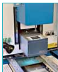
A precíziós beültetőfej, a tokot vákuumpipetta tartja, amelyet beépített vákuumszivattyú működtet
