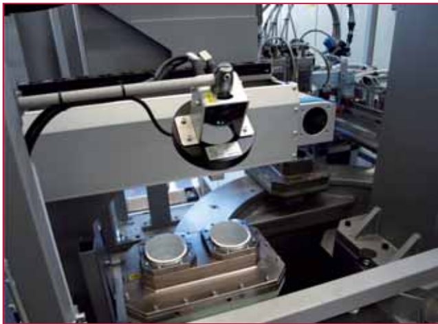
3. ábra. Bliszterezőgép körasztala, behelyezett poharakkal
