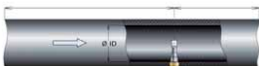
2. ábra. Az áramlás csövön belül változó profilja miatt a szenzor csúcsát a cső középségébe kell vezetni
