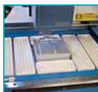
A kerámia infravörös sugárból álló, a kialakuló hőprofil 4 független termoelemmel ellenőrizhető
