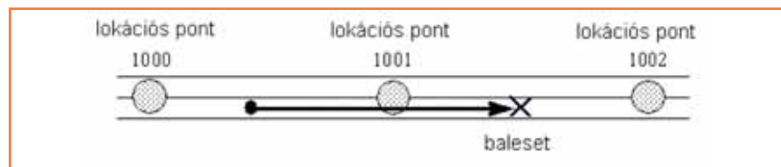
27. ábra. A baleset által érintett útszakasz elsődleges helyszíne az 1002, másodlagos helyszíne az 1000 számú lokációs pont
