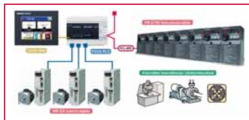
5. ábra. A kompakt FX3G PLC-vel költséghatékony, komplex rendszerek is építhetők, ugyanakkor a szervo- és frekvenciaváltós hajtásrendszerek programozása egyszerű.
