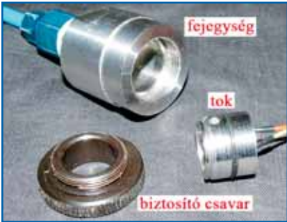
14. ábra. A nyomáspróbánál alkalmazott fej, biztosító csavar és a tok
