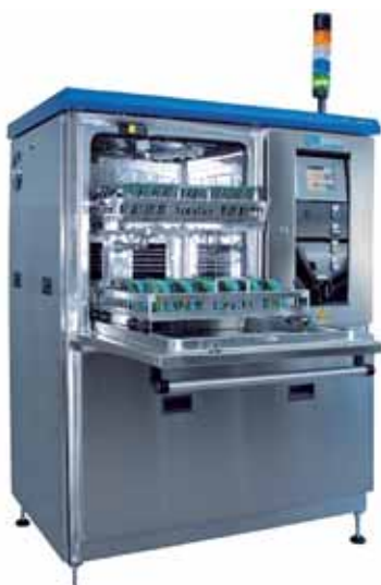
1. ábra. Egy minősített PCB- (nyomtatott áramkör) tisztítórendszerben a tisztítási folyamatot és a szükséges folyamatminősítést az öblítés alatt egy ionoszenyeződésmérő figyeli, a száradási hatékonyságot folyamatosan ellenőrzi és utánállítja
