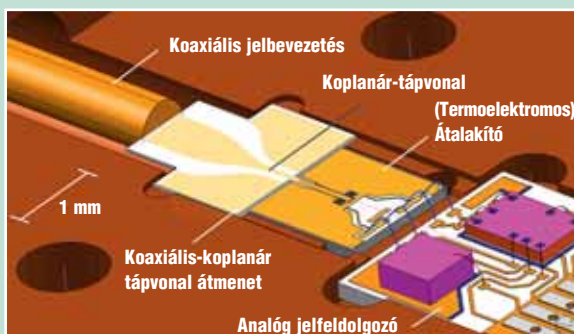
3. ábra. Az R&S®NRP-Z56 és az R&S®NRP-Z57 típusú termikus teljesítménymérő-fej (szabadalom által védett) rádiófrekvenciás bemeneti pontja
