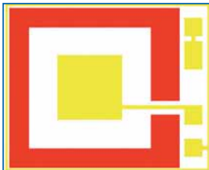
6. ábra. Az üveghordozón kialakított Al-fogyverzet (sárga) illeszkedése a Si-elektrodához (piros)
