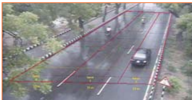
15. ábra. Detektálási zónák intelligens forgalom-ellenőrző rendszer kameraképén
