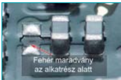
2. ábra. Folyasztszert-maradvány a sűrű, alacsony fekvésű alkatrészek alatt
