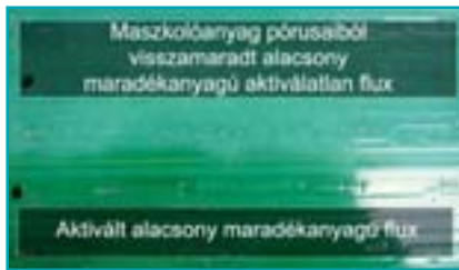
5. ábra. Száraz rétegű nedvszívás alacsony maradványú folyasztószer-használat mellett
