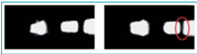
2. ábra. Példa a hibás és a hibátlan komponenseket tartalmazó képek közötti apró különbségre (Robert Bosch Elektronikai Kft.). Az a) ábra egy hibátlan forrasztást tartalmazó pint mutat. Látható, hogy ettől a b) ábrán lévő hibás forrasztás alig tér el, amelynek detektálása komoly feladat
