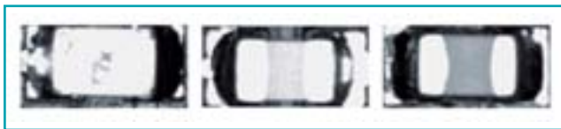
3. ábra Ugyanolyan típusú alkatrészek (C0805) különbözősége (Robert Bosch Elektronikai Kft.)
