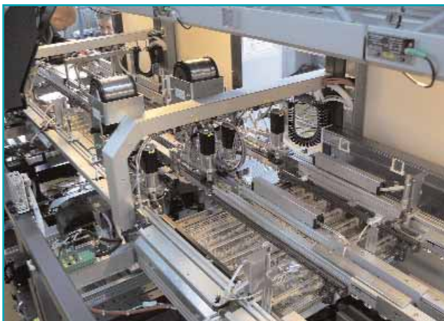
2. ábra. Kettős szállítópálya Versaflow 3 gépben
