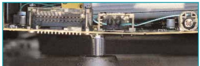
4. ábra. A forraszhullám vezetését a panel behajlásához igazíthatjuk a szoftver segítségével
