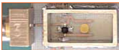
55. ábra. Dielektromos oszcillátor kialakítása
