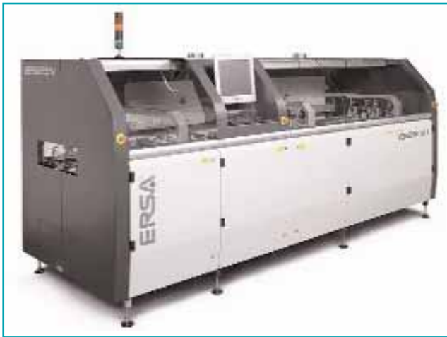
1. ábra. Az ERSÁ Versaflow 3 in-line szelektív forrasztógépe
