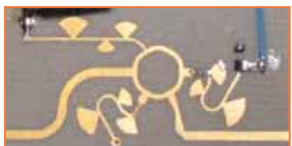
57. ábra. Kétdiódás keverő kialakítása
