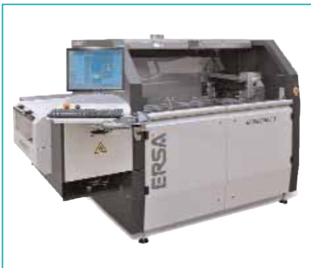
5. ábra. Az ERSA Ecosselect 2 kompakt szelektív forrasztógép a Versaflow 3 technológiájával
