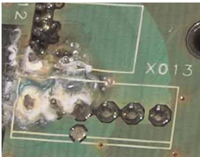
A bevonat delaminációja
