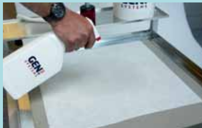
2. ábra. A stenciltisztítás lépesei. A tisztítási művelet négy egyszerű lépésből áll:
