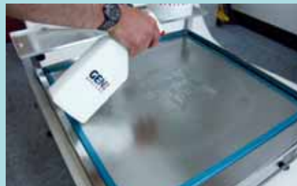
2. ábra. A stenciltisztítás lépesei. A tisztítási művelet négy egyszerű lépésből áll:
