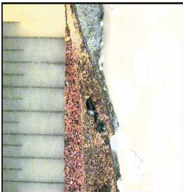
1. ábra. A flexibilis polimer kivezetéstechnológia (AVX)
