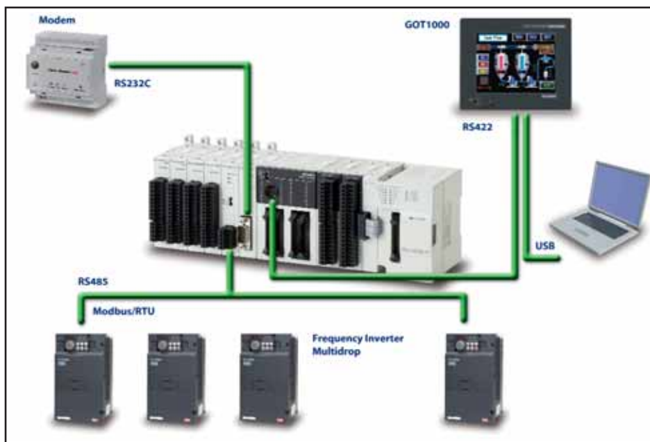
2. ábra. A kisebb automatizálási alkalmazásokhoz tervezett új MELSEC FX3G a Mitsubishi Electric nagy teljesítményű FX3 kompakt vezérlőcsaládjának teljes jogú tagja
