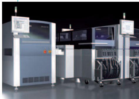
1. ábra. Siplace OS: párhuzamos 2D/3D vizsgálat elsőként a világon
