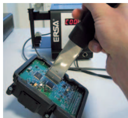
4. ábra. Akár kiserelés nélkül, házba építve is kicserélhetünk egy alkatrészt
