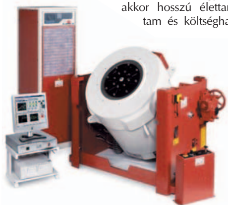
1. ábra. LDS integrált rázórendszer felépítése: teljesítményerősítő, rázófej, szoftveres szabályozás
