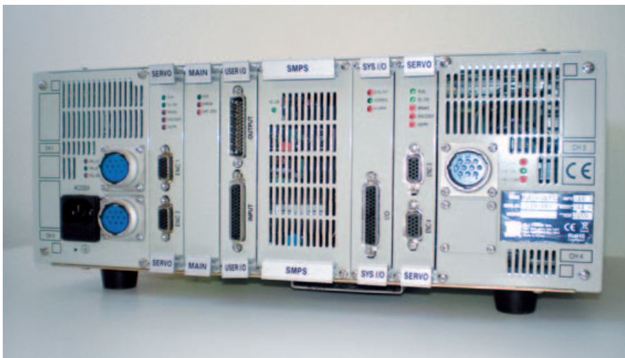
3. ábra. A diszpenzerrobot vezérlője
