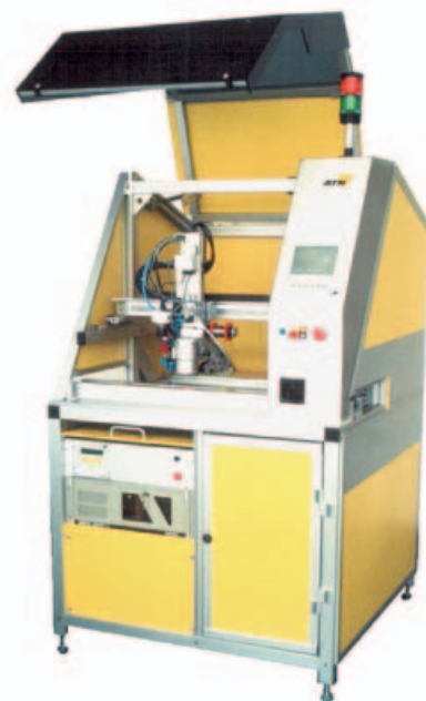
4. ábra. ECONOMIC asztali robot a nulla- és kisszériák csekély költségű automatizált forrasztására
