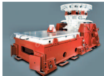
6. ábra. LDS nagy teljesítményű rázófej – horizontális irányú teszthez rázóasztalal kiegészítve
