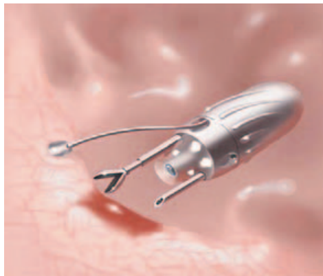
3. ábra. Emberi szervezeten belül navigál(hat)ó, MEMS-alapú orvosi műszer koncepciója
