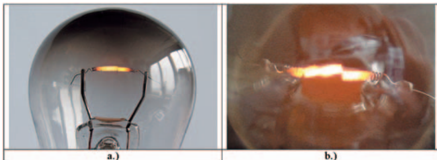
5. ábra. Az elhasznált izzó: (a) a ballon falára lecsapódott volfrám besötétítette az üvegballont; (b) az izzószál szerkezeti deformációja
