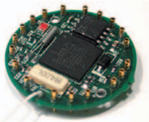
9. ábra. A Crossbow MICA2DOT mote ([14], [15]). Magában foglalja a multitask operációs rendszer futtatására alkalmas, Atmel-gyártmányú processzort, a rádiós modult és számos érzékelőt. Átmérője mindössze 25 mm
