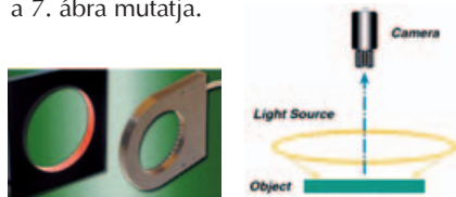
7. ábra. Árnyékvilágítás és működése
