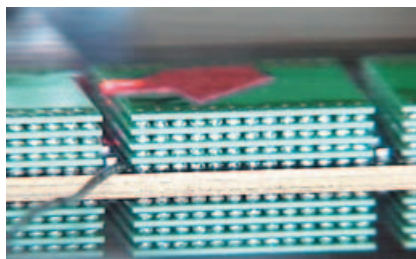
4. ábra. „Ezt kapd ki!” – mondja a köznyelv a nehéz feladat szinonimájaként. Itt szó szerint értendő: az egymásra forrasztott BGA rakatból csak a piros címkével jelölt legfelsőt kell kiforrasztani, úgy, hogy az alatta lévőek ott maradjanak, a mellette lévőek forrasztásai nem olvadhatnak meg. Az IR550 berendezéssel sikerült
