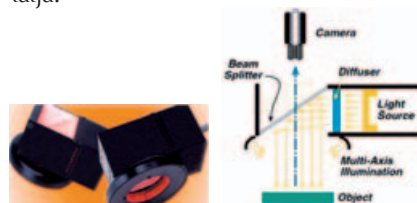
15. ábra. Kombinált megvilágítás és működése
