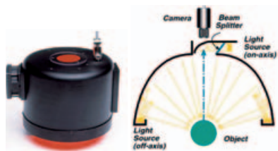
9. ábra. Fátyolvilágítás és működése
