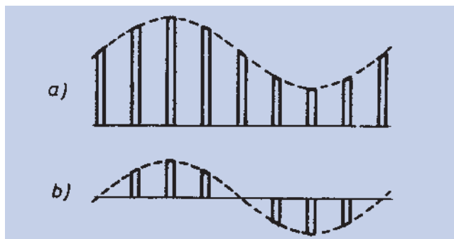
11. ábra. Unipoláris és bipoláris impulzus amplitúdó – PAM – moduláció
