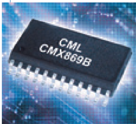
1. ábra. Nagy sebességű modemáramkör a CML-től
