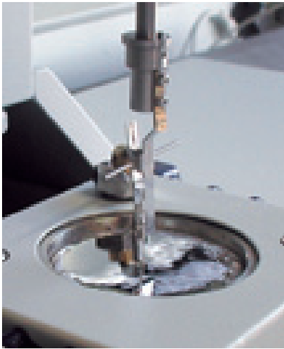
4. ábra. Ellenállás huzalkivezetésének vizsgálata MUST II berendezésen forraszfürdőben
