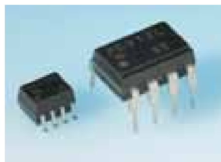
2. ábra. A Sharp nagy sebességű optocsatolói
