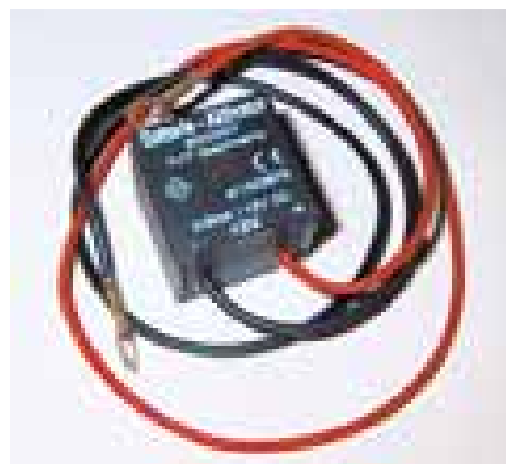
8. ábra. Akkumulátor-karbantartó elektronika
