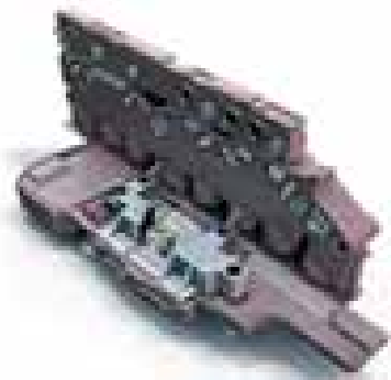
3. ábra. Automata sebességváltóba integrált vezérlő elektronika
