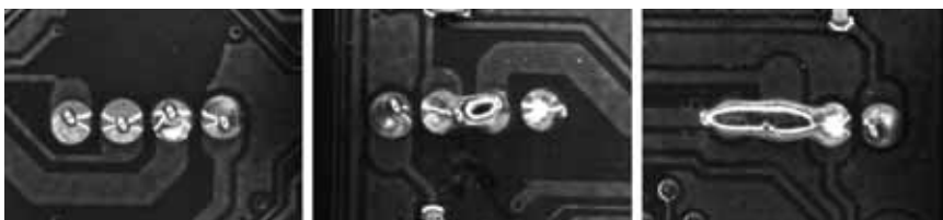
6. ábra. Hibátlan (bal) és rövidrezárt forrasztások kameraképe
