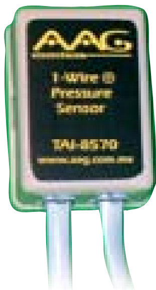
7. ábra. A légnyomás-érzékelő – a többi egyszerű érzékelőhöz hasonlóan – telefoncsatlakozó házba lett beépítve
