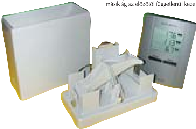
8. ábra. A csapadékmennyiség-mérő mechanikailag is szép konstrukció
