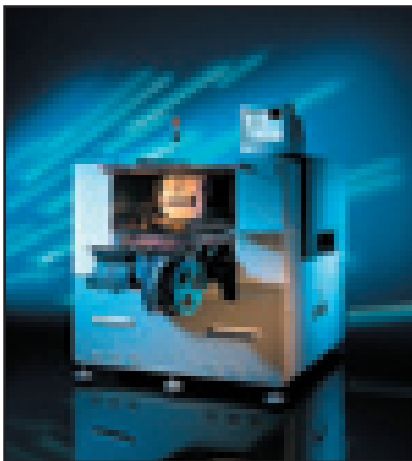
2. ábra. Az AdVantis AFC-42 flip-chipet is be tud ültetni
