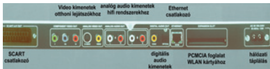
7. ábra. A készülék bekötési csatlakozói
