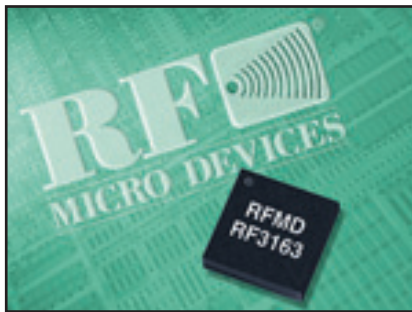
12. ábra. 3x3 mm-es teljesítményerősítő az RF Micro Devices-től
