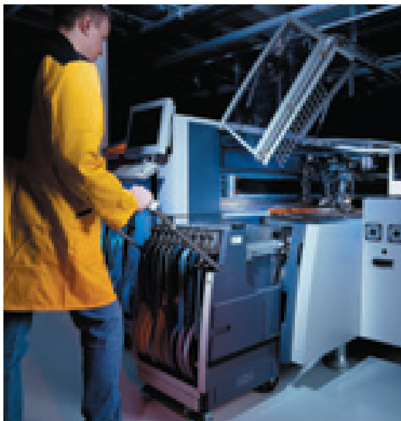
1. ábra. A Siplace összefűző rendszer mentesíti a beültetőgépeket a drága állásidőtől
