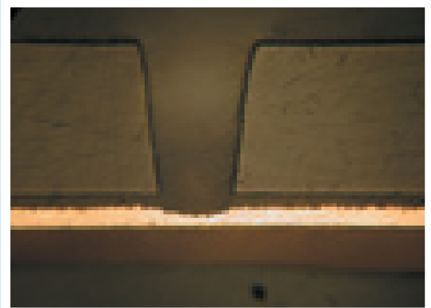
2. ábra. 25 \mu\text{m} átmérőjű mikrovia polimer hordozón [2]
