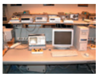
2. ábra. A polcon: multiméter, generátor, tápegység; az asztalon: oszilloszkóp, mérendő panel
