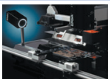
2. ábra. Ersa IR 550A összeépítve PL 550A alkatrészhelyező berendezéssel és folyamatfigyelő kamerával (RPC). A tárgyasztal a helyezettől a reflowegységhez precíziós vezetéken gördül
