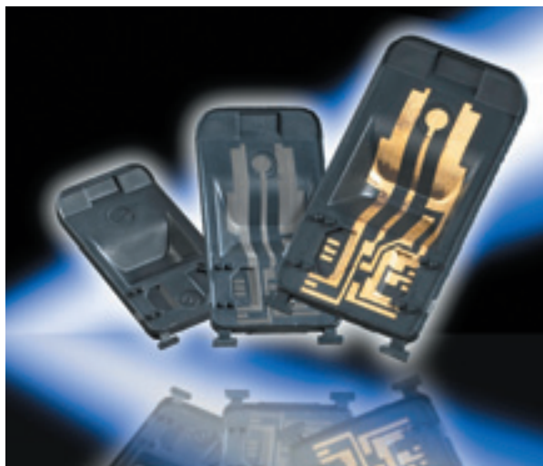
4. ábra. Készülékházon kialakított nyomtatott huzalozás
