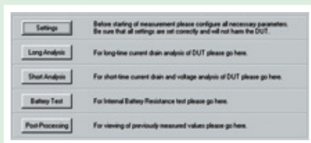
2. ábra. Az R&S® NGMO2-K10 kezelőprogrammal elvégezhető mérések
