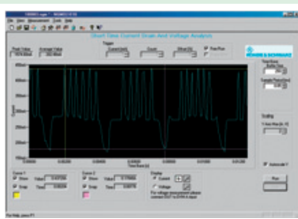
5. ábra. Régebbi, GSM-rendszerű mobiltelefonon végzett, rövid idejű áramfelvétel-analízis
