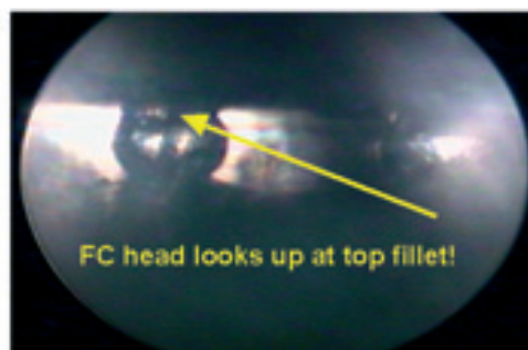
2. ábra. Az eredeti ERSASCOPE-fej tökéletesen megfelel normál BGÁ-khoz, de a jóval kisebb flip chipek golyócskáinak felső része takarásban marad. Az új Flip Chip-fej akár 0,03 mm-es résbe is képes bepillantani, és megmutatni a felső forrasztási meniszkuszt is.
