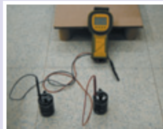
7. ábrán. Fajlagos felületi ellenállás helyszíni mérése
