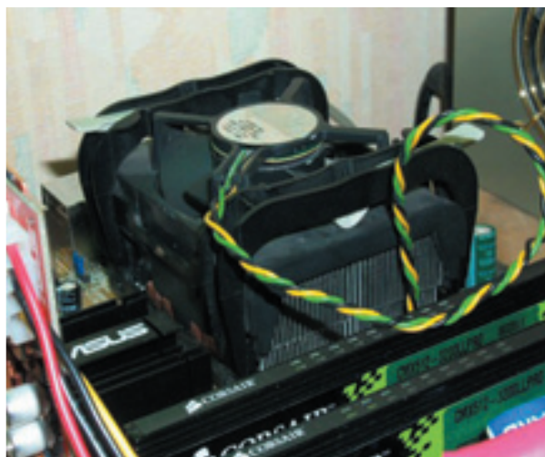
5. ábra. Pentium 4 Prescott lapka hűtőtömbbel és ventilátorral
