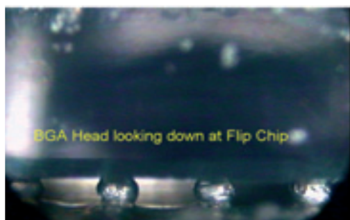
2. ábra. Az eredeti ERSASCOPE-fej tökéletesen megfelel normál BGÁ-khoz, de a jóval kisebb flip chipek golyócskáinak felső része takarásban marad. Az új Flip Chip-fej akár 0,03 mm-es résbe is képes bepillantani, és megmutatni a felső forrasztási meniszkuszt is.
