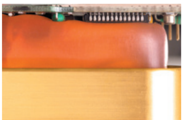
4. ábra. Univerzális alátámasztás kétoldalas stencilnyomtatáshoz
