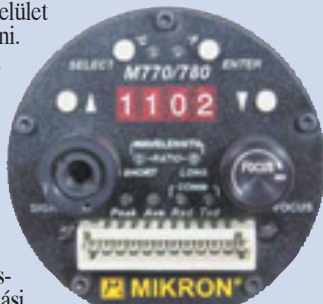
2. ábra. Az infrahőmérő kezelőszervei sokrétű helyszíni beállítást tesznek lehetővé
