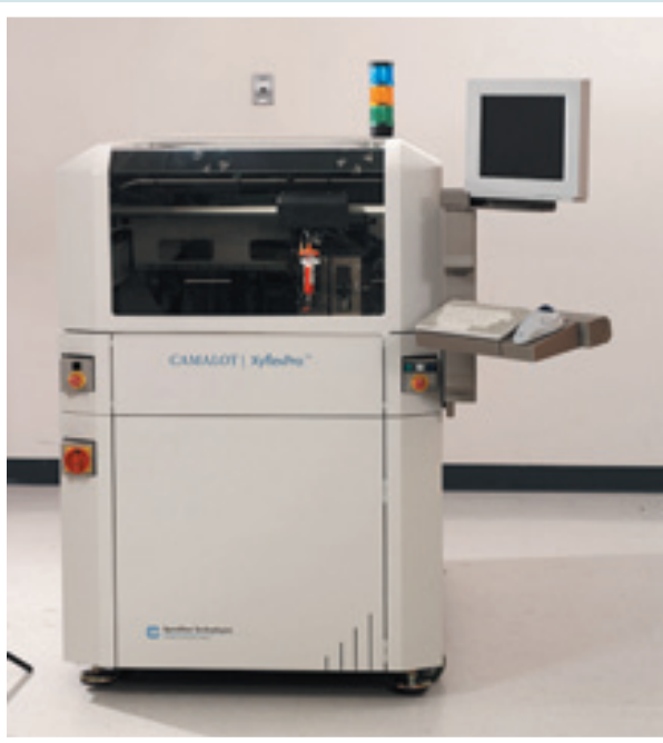
6. ábra. A XyflexPro DLM kétsoros adagológépe
